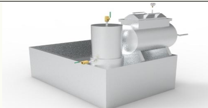
Gambar 4. Desain 3D Mesin Vacuum Frying yang dirancang untuk meningkatkan efisiensi pengolahan rambutan.
